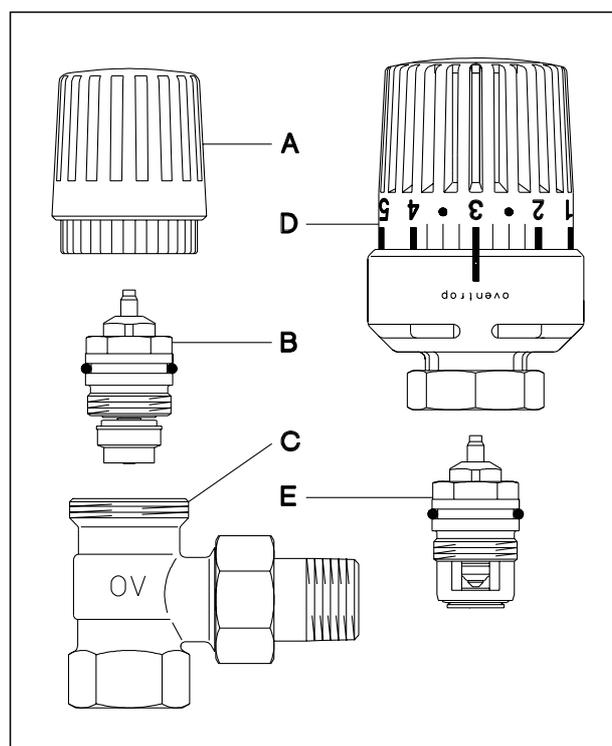
Вентили Oventrop с ручным приводом серии „НА”
