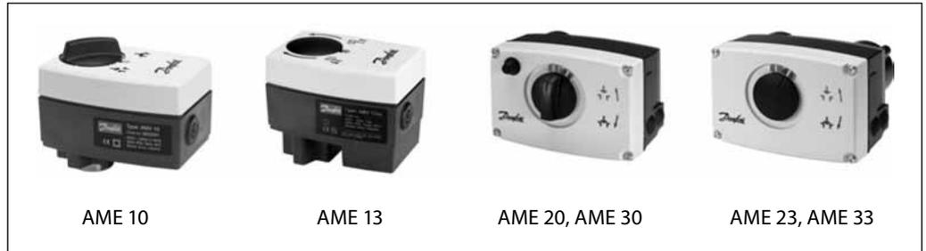
Электроприводы предназначены для работы с регулирующими клапанами VS2, VM2, VB2. Приводы управляются аналоговым сигналом типа Y. Существуют варианты данного электропривода с защитной функцией. Устройство защиты (возвратная пружина) позволяет закрыть регулирующий клапан при обесточивании системы.
